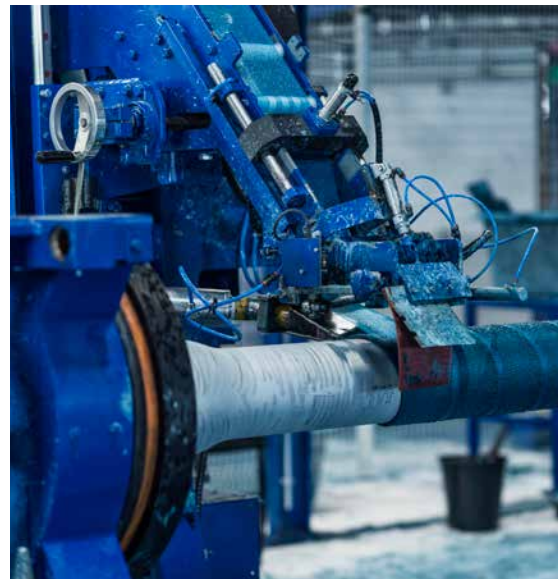
ZMU-Austria (rivestimento di malta cementizia)
