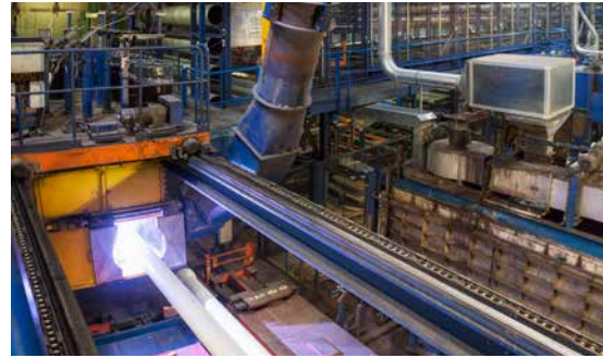
Zincatura a caldo applicata a spruzzo
