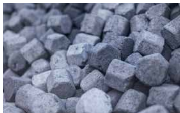
Carburo di silicio per aumentare il contenuto di silicio nel ferro
