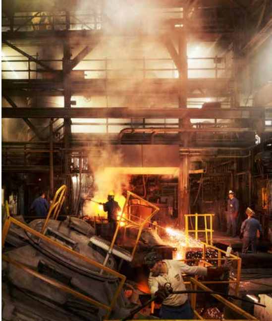
Forno a cupola con forno a canale in primo piano
