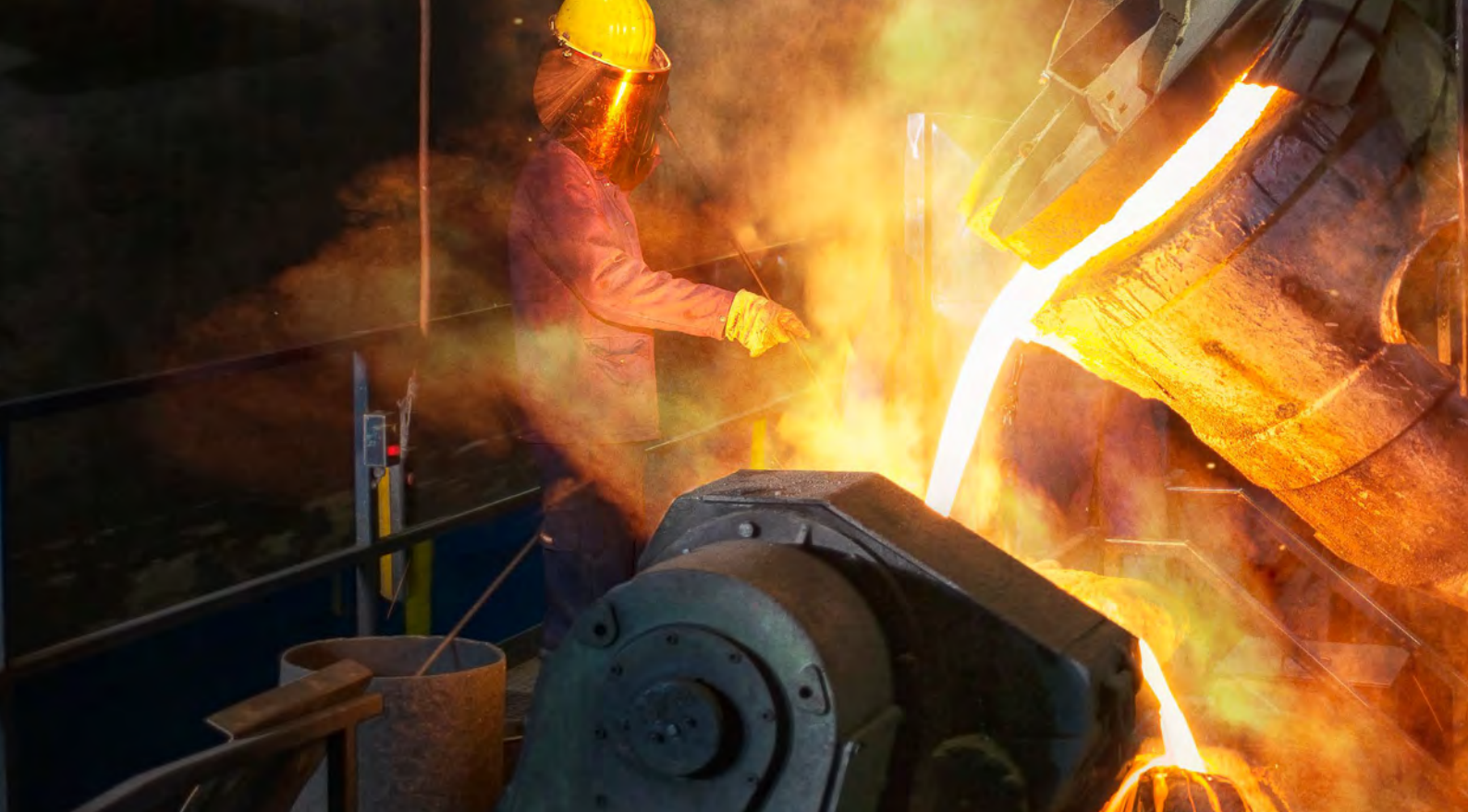
Befüllung der Schleudergussmaschine
