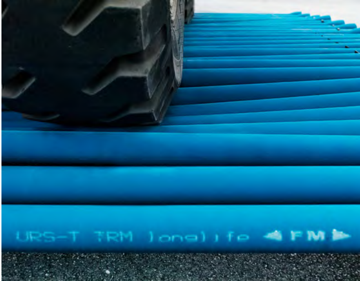
Belastungsdemonstration mit Radlader
