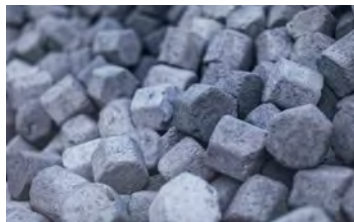
Siliziumkarbid zur Anhebung des Siliziumgehalts im Eisen
