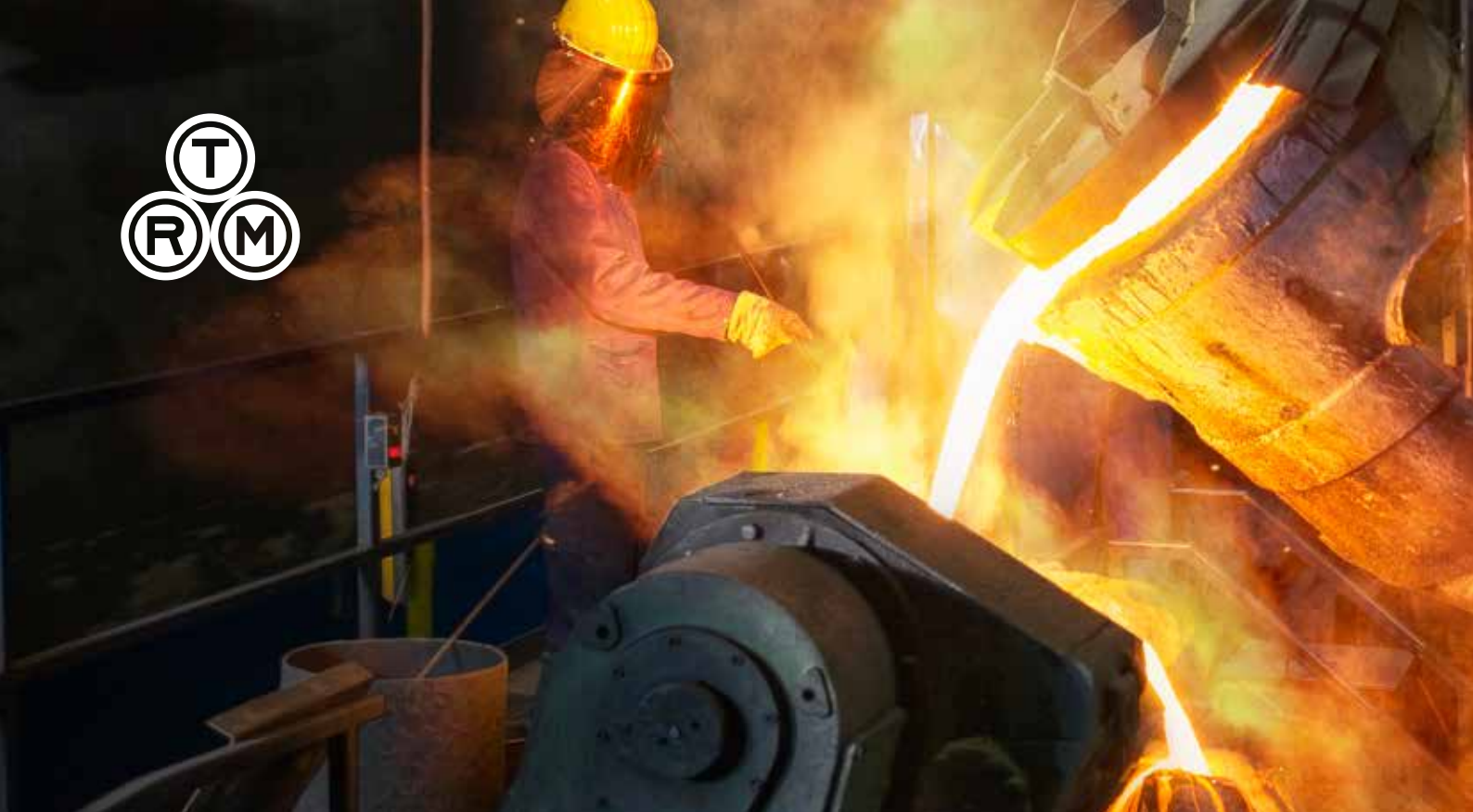
Riempimento della macchina a colata centrifuga
