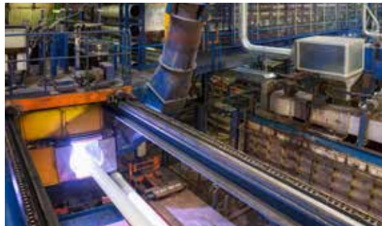
Zincatura a caldo applicata a spruzzo
