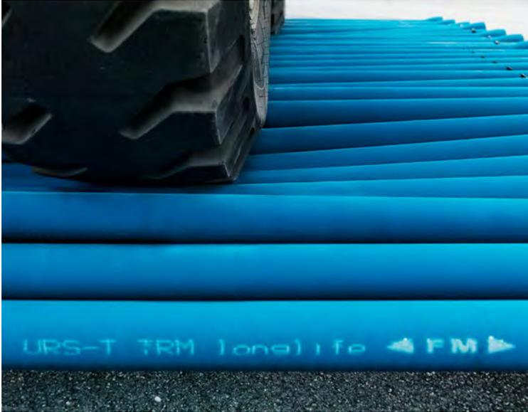
Belastungsdemonstration mit Radlader
