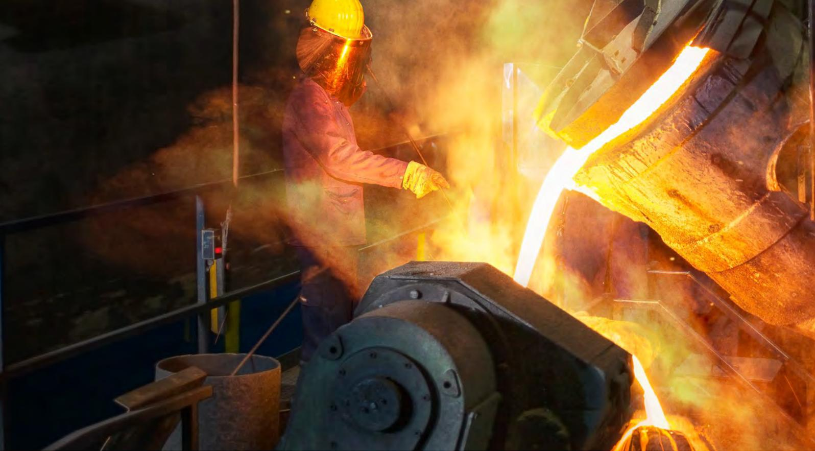
Befüllung der Schleudergussmaschine
